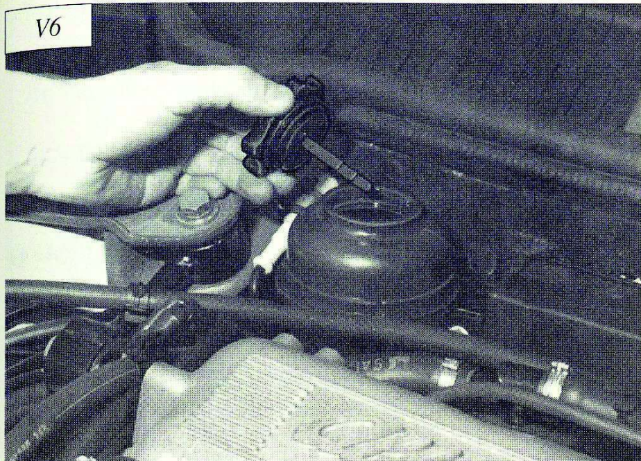
Ölbehälter der Servolenkung
